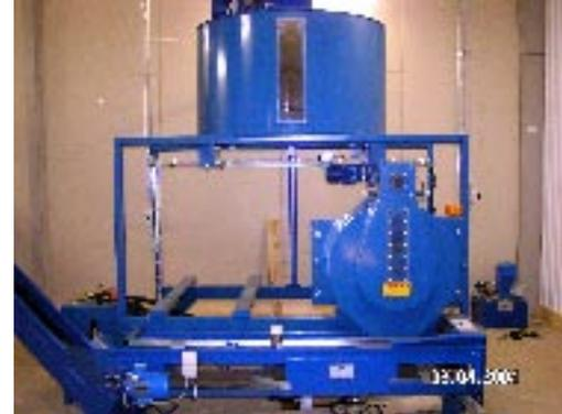
Для производства 1 тонны пеллетов требуется примерно 6м3 опилок или стружки. Пресс мощностью в 250-350 кг/час может вырабатывать примерно 2000 тонн пеллетов в год. 2000 тонн пеллетов могут заменить примерно 1000 тонн дизельного топлива и уменьшить выбросы CO2 на 300 тонн в год. Поэтому от такого производства выигрывают все.
